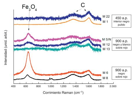
Figura 7. Espectrograma Raman para las zonas negras de las muestras del sitio Pintoscayoc 1 analizadas. Raman Spectrograph for the black areas of the samples analyzed from Pintoscayoc 1 site.
