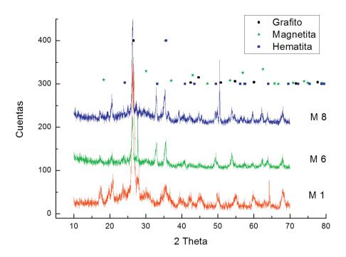
Figura 6. Difractograma de DRX para las zonas negras de las muestras M 8, M 6 y M 1. XRD diffractogram for the black areas of samples M 8, M 6 and M 1.
