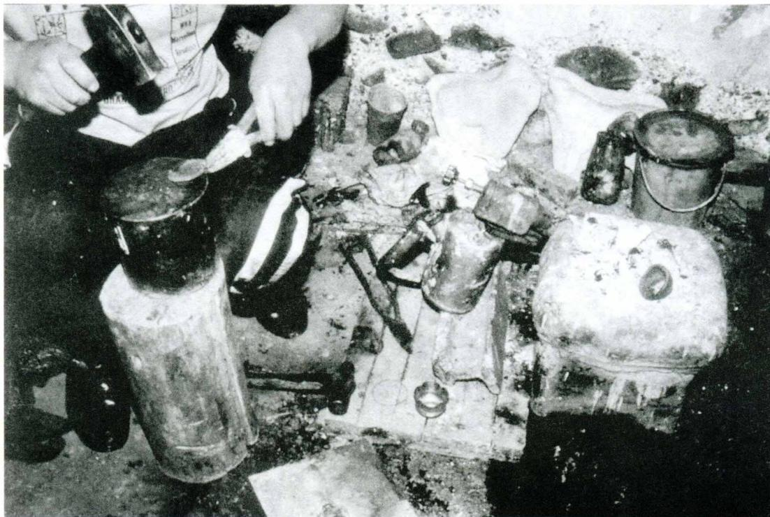
Figura 17. Martillado en el yunque de la placa de plata.
