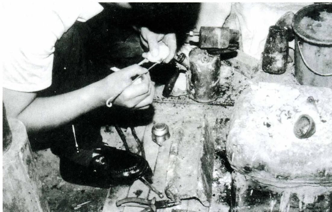
Figura 18. Añadir el flujo y de un pequeño trozo de plata a una fisurita.
