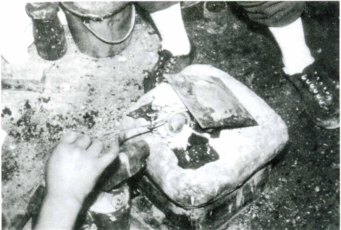
Figura 14. La fundición de la plata después de añadir el flujo.
