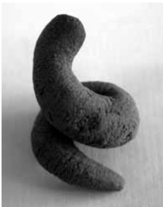
Figura 6. Muestra de arcilla cocida que mantiene su forma.
