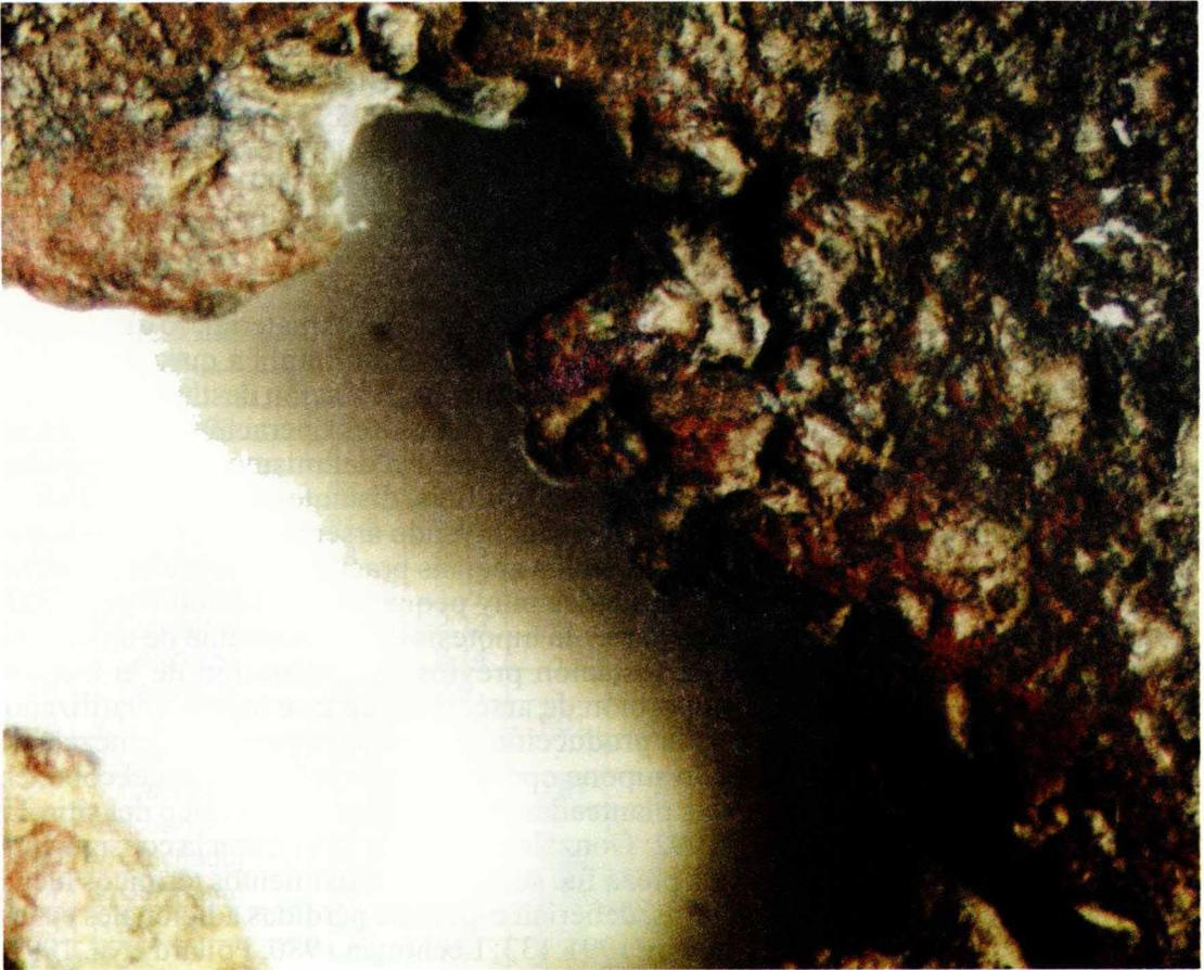
Figura 8. Bordes redondeados en el agujero del disco, sin rastros de corrosión (6,7x).
