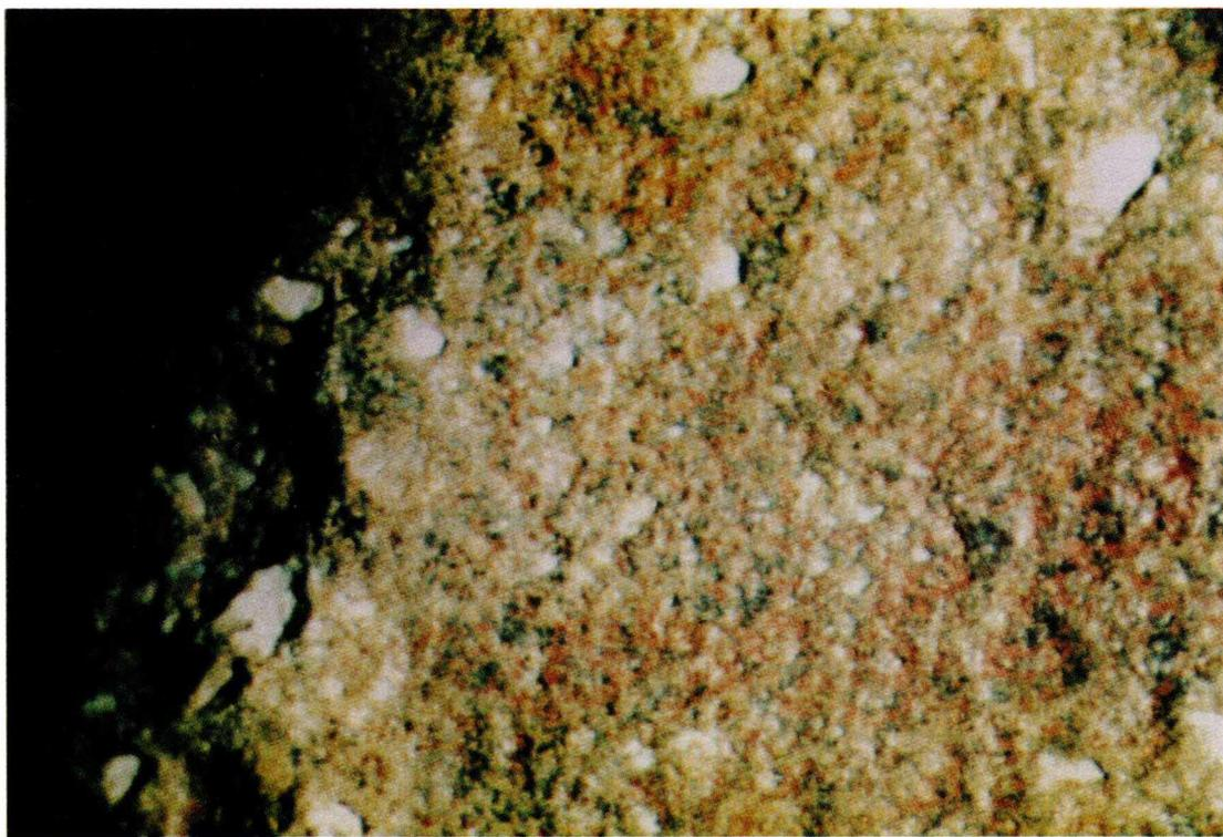
Figura 5. Inclusiones blanquecinas de un compuesto de calcio en el metal. Probablemente provengan del recubrimiento del refractario utilizado (6,7x).
