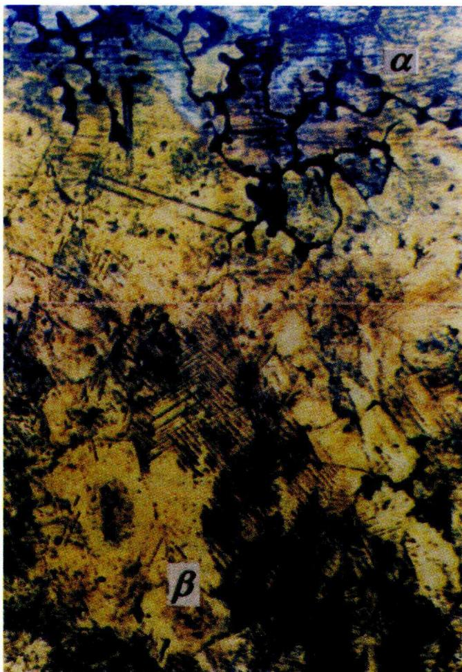
Figura 7. Microestructura en la zona de inserción de la misma "oreja" (100x). En la zona *alfa* se observan anomalías en los espacios interdentriticos y que indican discontinuidad en el material. En la zona *beta*, se aprecia la interfase hacia la superficie del disco, con la presencia de bandas de deslizamiento.
